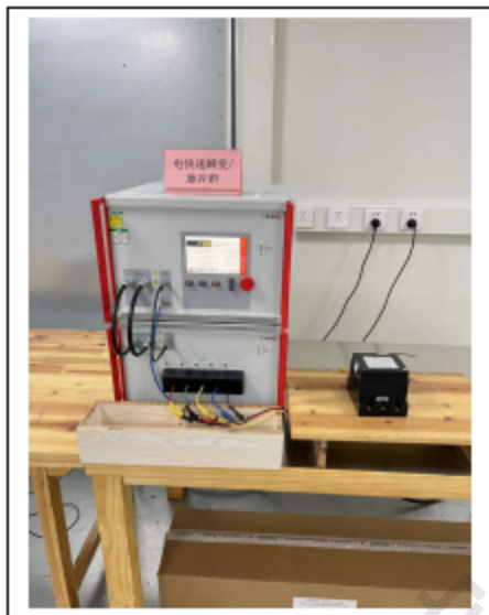
电快速瞬变/脉冲群抗扰度
